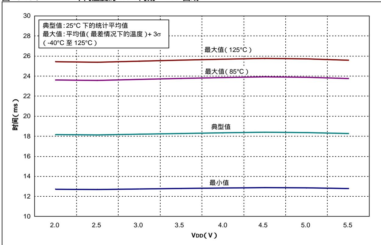
图 18-19： 不同 VDD 的 WDT 周期 - 温度曲线 (5.0V)
