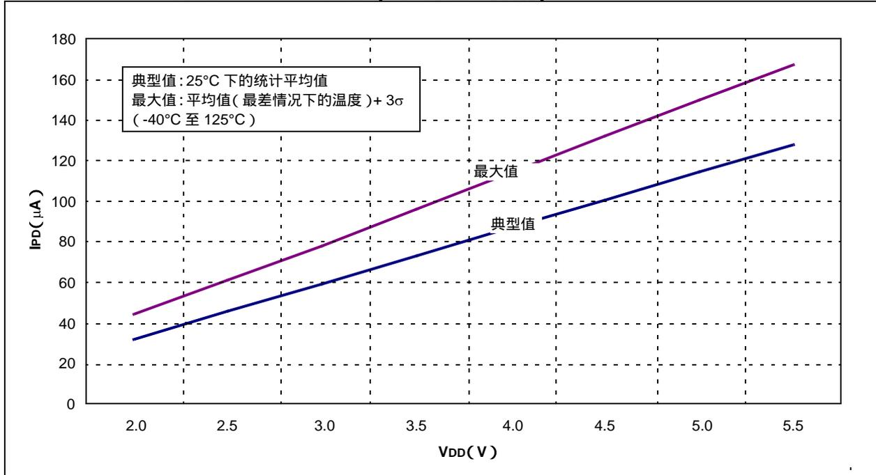
图 18-15 : 不同温度的 BOR IPD - VDD 曲线
