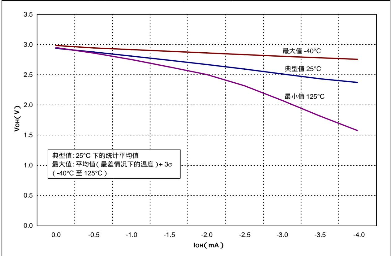
图 18-25 : 不同温度的  $V_{OH}$  -  $I_{OH}$  曲线 ( $V_{DD} = 5.0V$ )
