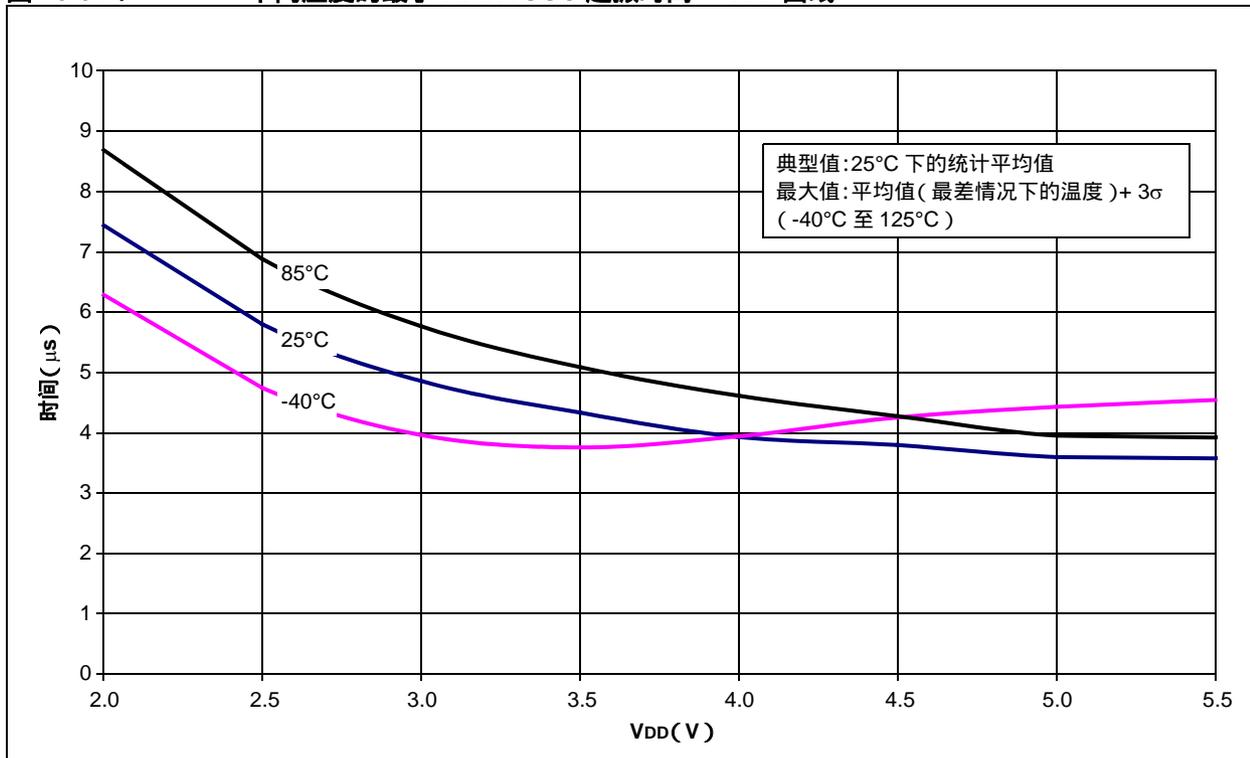
图 18-35 : 典型 HFINTOSC 频率变化 - VDD 关系曲线 (25°C)
