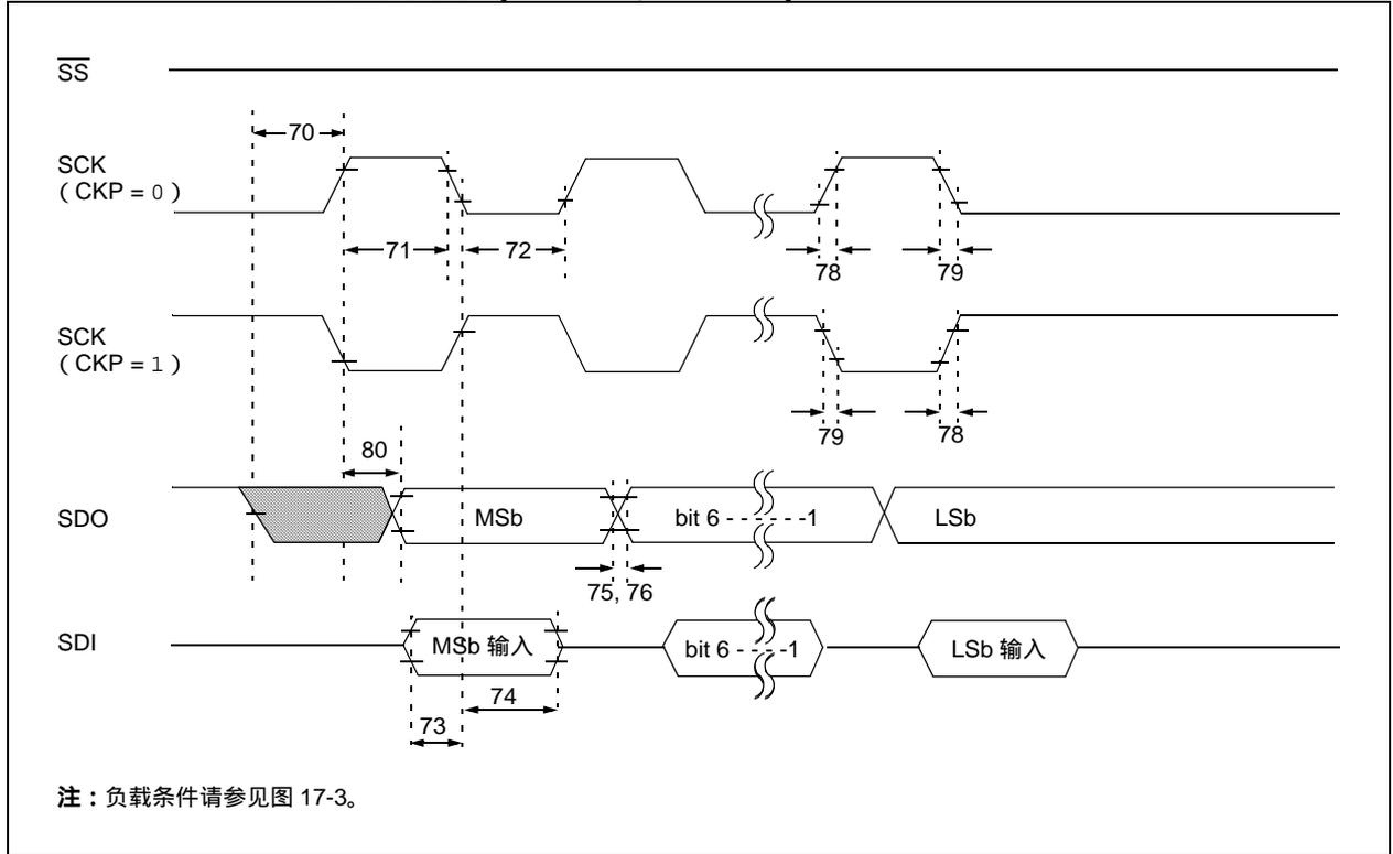
图 17-13: SPI 主模式时序 (CKE = 1, SMP = 1)
