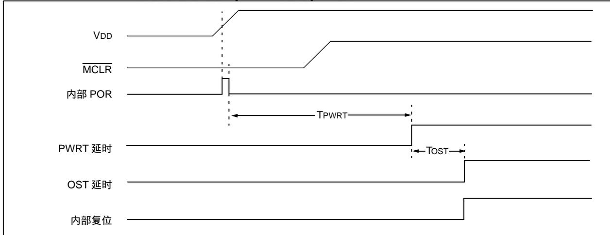
图 14-5 : 上电时的延时时序 (MCLR 延时): 情形 2
