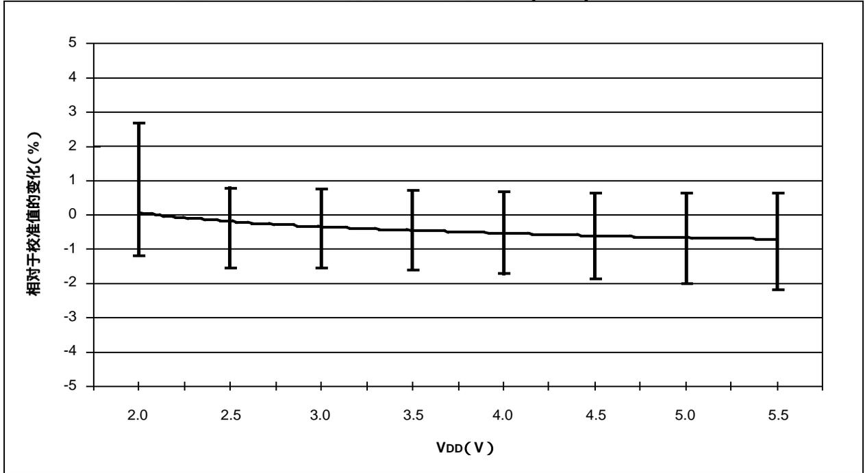
图 18-37 : 典型 HFINTOSC 频率变化 - V<sub>DD</sub> 关系曲线 (125°C)
