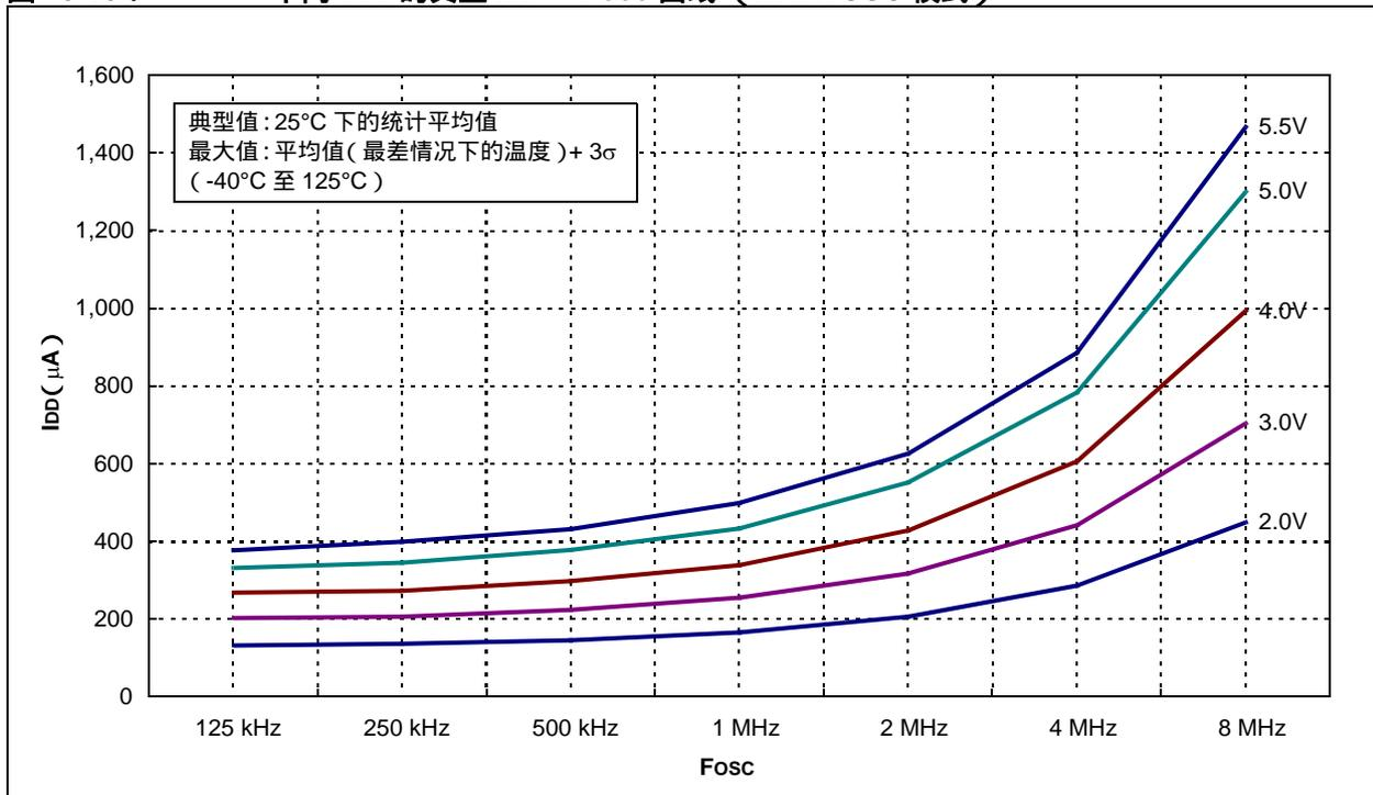
图 18-11 : 不同 VDD 的最大 IDD - Fosc 曲线 (HFINTOSC 模式)
