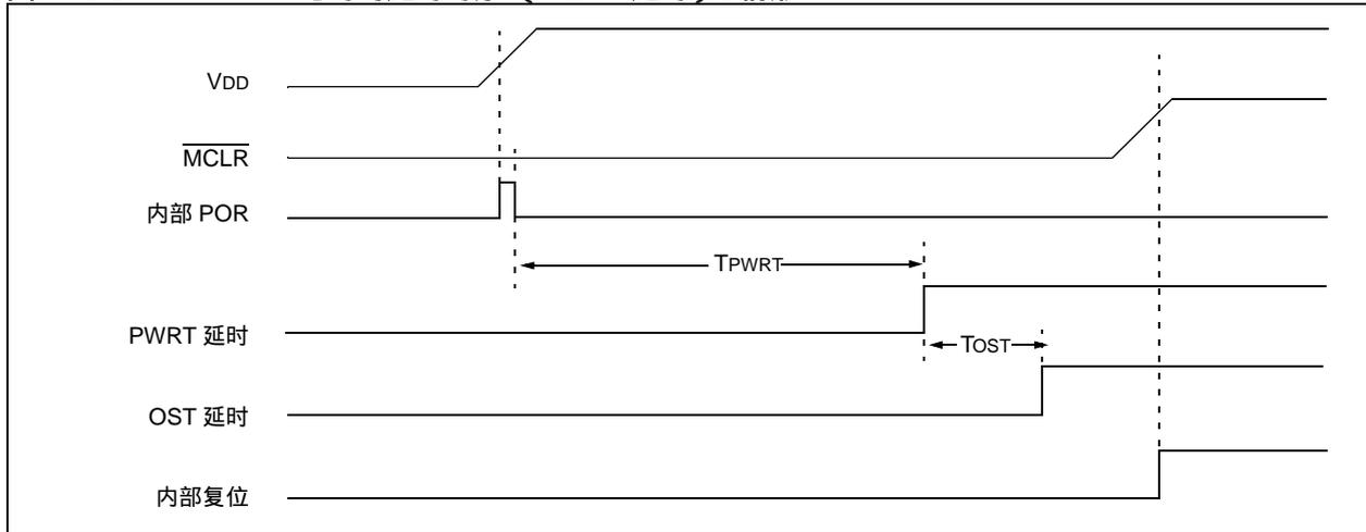
图 14-6 : 上电时的延时时序 (带有 VDD 的 MCLR)
