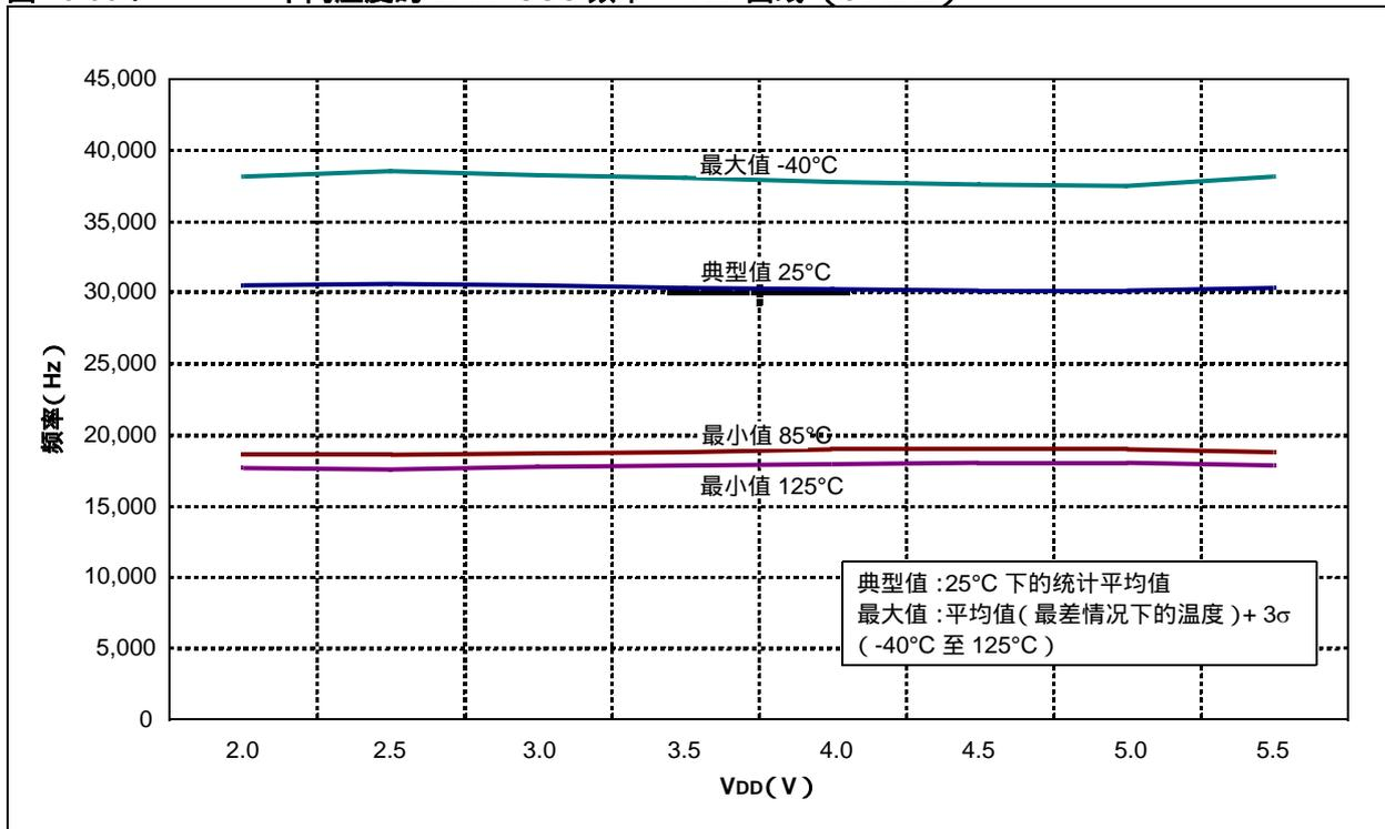
图 18-31 : 不同温度的 ADC 时钟周期 - VDD 曲线
