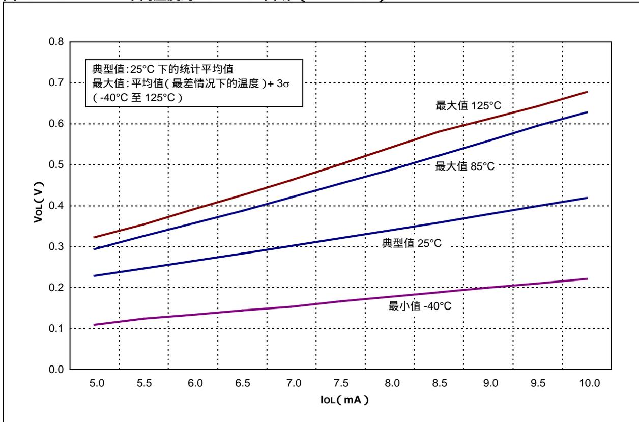
图 18-23 : 不同温度的 VOL - IOL 曲线 (VDD = 5.0V)
