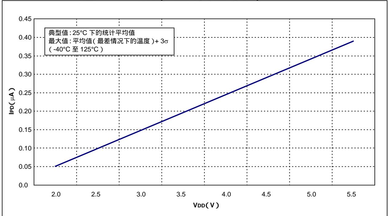
图 18-13： 最大 IPD - VDD 曲线（休眠模式，禁止所有外设）
