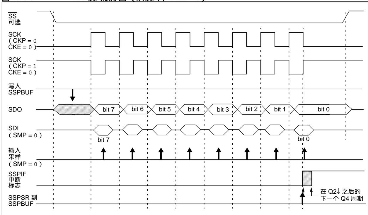
图 13-6: SPI 模式波形图 (从模式, CKE = 1)
