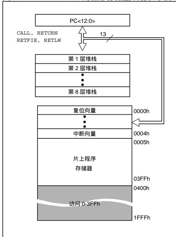
图 2-2：PIC16F685/689/690 的程序存储器映射和堆栈
