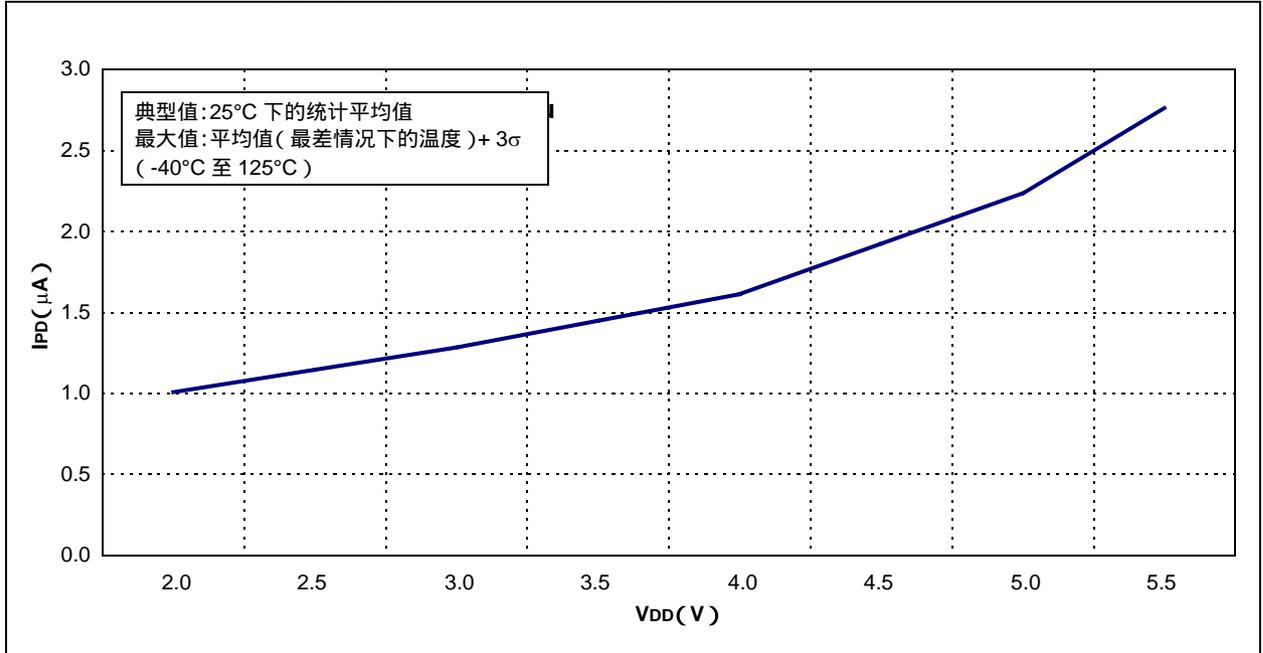
图 18-17 : 不同温度的最大 WDT IPD - VDD 曲线
