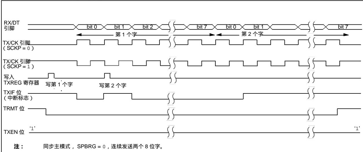
图 12-11： 同步发送（由 TXEN 位控制）
