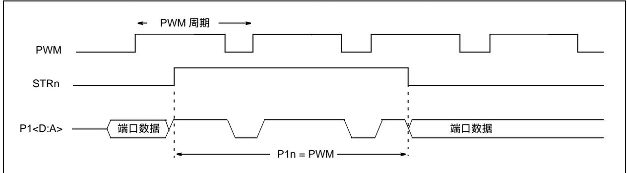
**图 11-20：** 指令开始时发生的转向事件的示例 (STRSYNC = 1)
