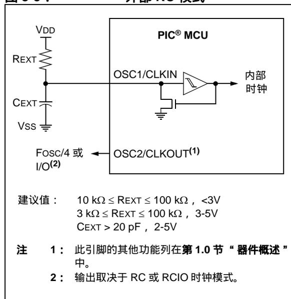
在 RCIO 模式下, RC 电路连接到 OSC1。OSC2 成为额外的通用 I/O 引脚。
