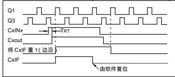
图 8-5：比较器中断时序（带 CMxCON0 读取）
