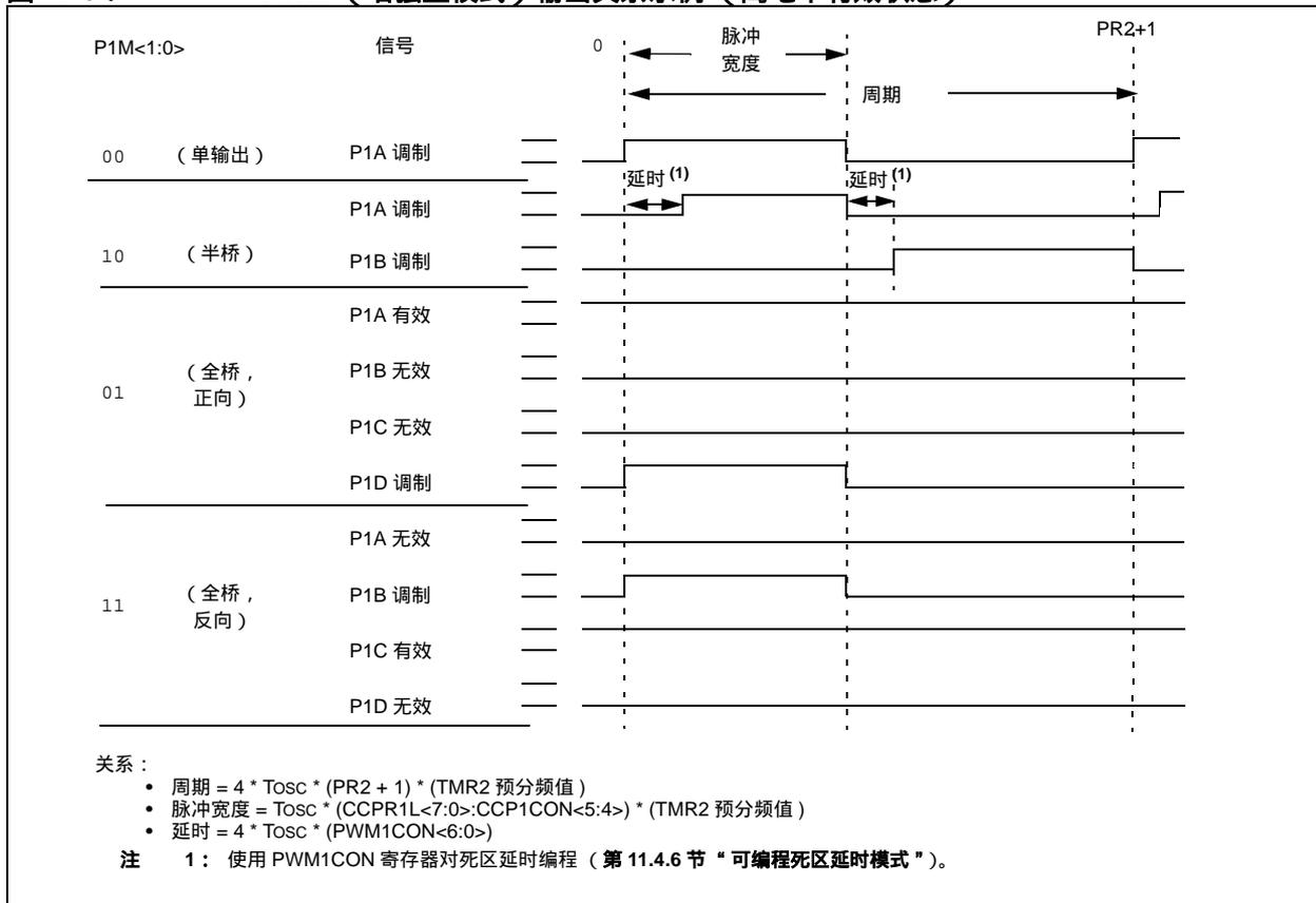
图 11-7 : 增强型 PWM 输出关系示例 (低电平有效状态)
