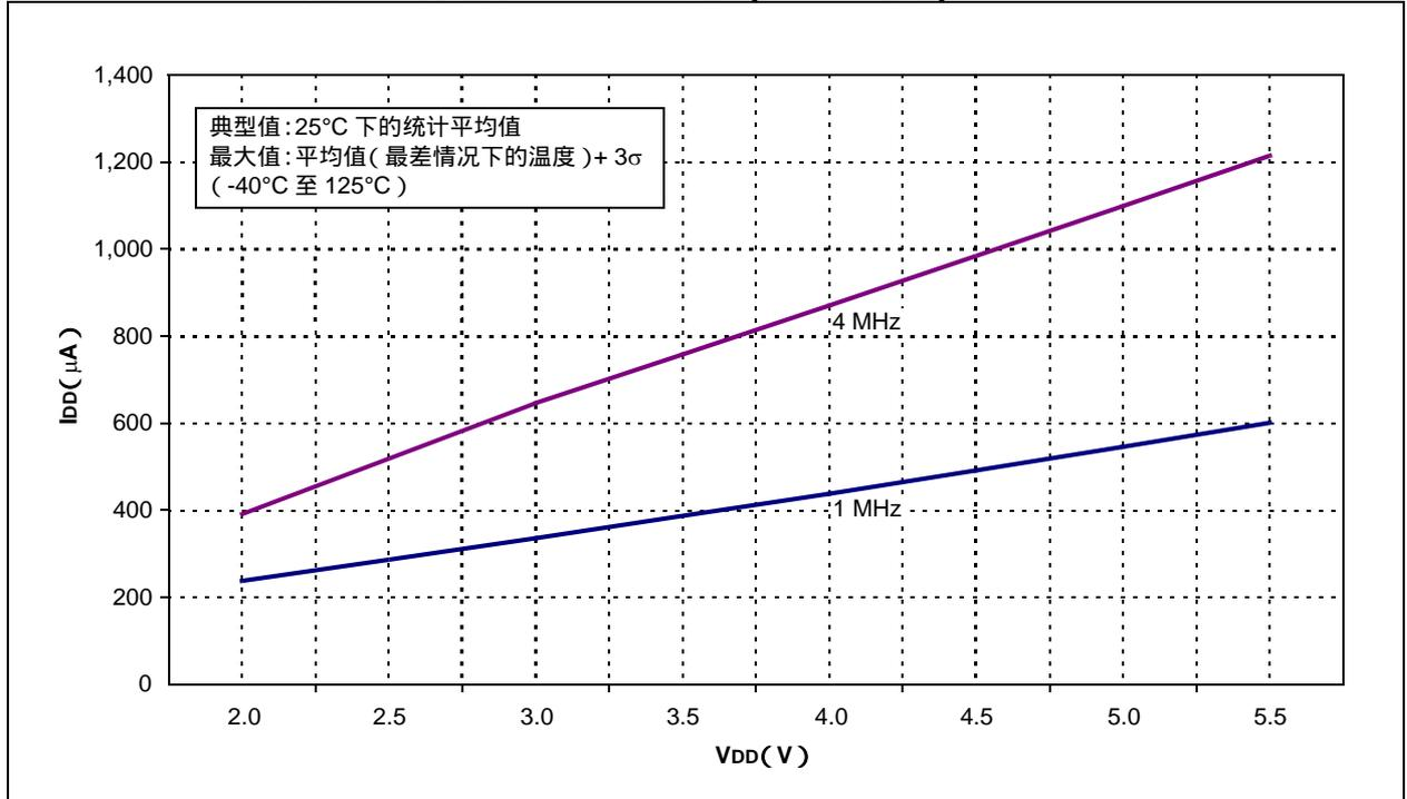
图 18-9 : 不同 FOSC 的 I<sub>DD</sub> - V<sub>DD</sub> 曲线 (LFINTOSC 模式, 31 kHz)
