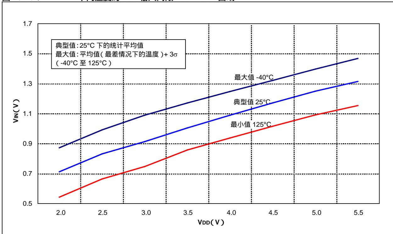
图 18-27 : 不同温度的施密特触发器输入门限  $V_{IN} - V_{DD}$  曲线
