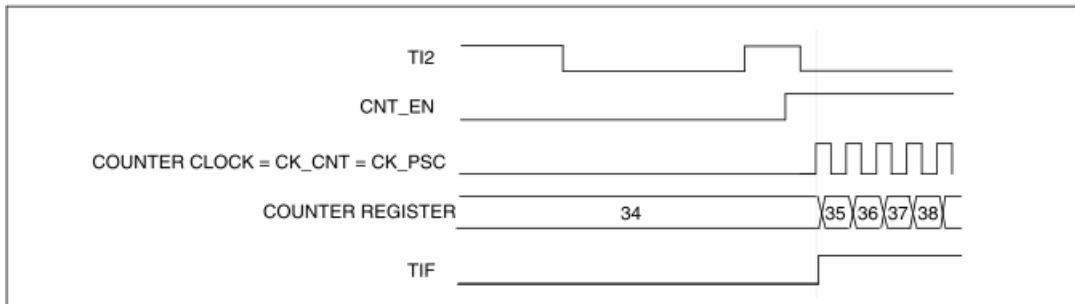
图46 标准触发模式的控制电路
