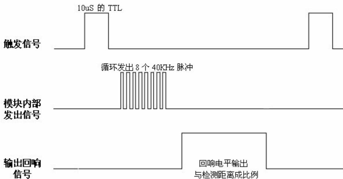
以上时序图表明你只需要提供一个10uS 以上脉冲触发信号，
