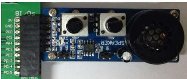
➤ 将 Analog Test Board 模块接入 SPI+ADC 接口
