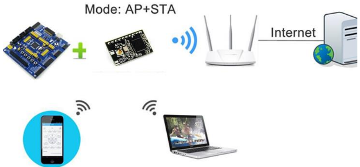
图 19. WIFI-LPT100-B 的 AP+STA 组网结构 模块在 AP+STA 模式下，其中 AP 最多只能支持接入 3 个 STA 设备。
