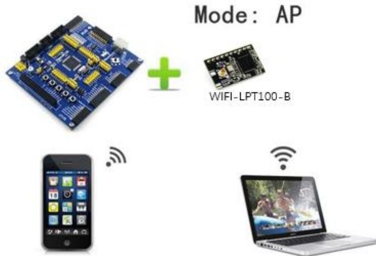
图 18. WIFI-LPT100-B 的 AP 组网结构
