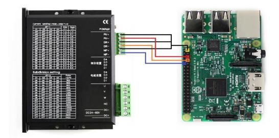
【注意】共阴接法: 高电平有效; 共阳接法: 低电平有效
